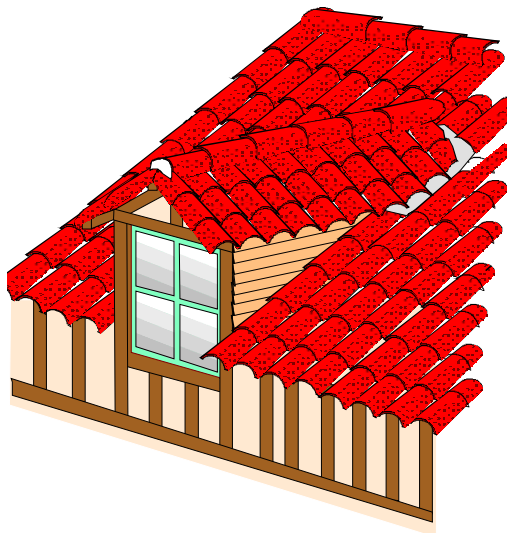
Lucarne traditionnelle autorisée sur l'architecture à structure bois sur les constructions neuves en zones P1 et AP1
